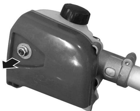
Placez le guide chaîne de façon à ce que la goupille de sécurité de la chaîne vienne s'engager dans les dents de celle-ci. Veillez à ce que le sens du mouvement de la chaîne de coupe soit correct. Installez la protection de la chaîne et serrez la vis de fixation
